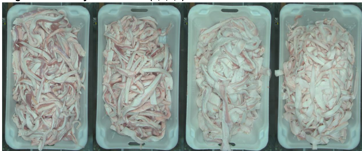
Figur 3. Billedeksempler fra visionudstyret, der viser vurderingen af skærekvalitet ift. 4-trinsskala-klassificering af produkter i kasser målt i drift på værtsslagteriet.
