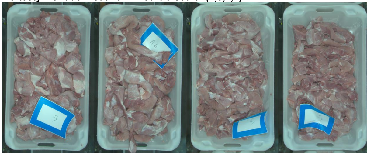
Figur 5. Billedeksempler fra visionudstyret, der viser vurderingen af skærekvalitet ift. 4-trinsskala-klassificeringen af hoftestykker målt i drift på værtsslagteriet.
