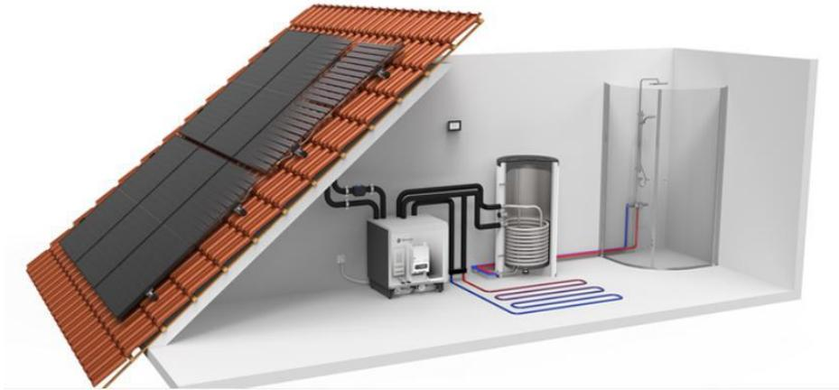
Figure 78: Complete PVT energy system from Nærvarmeværket.
