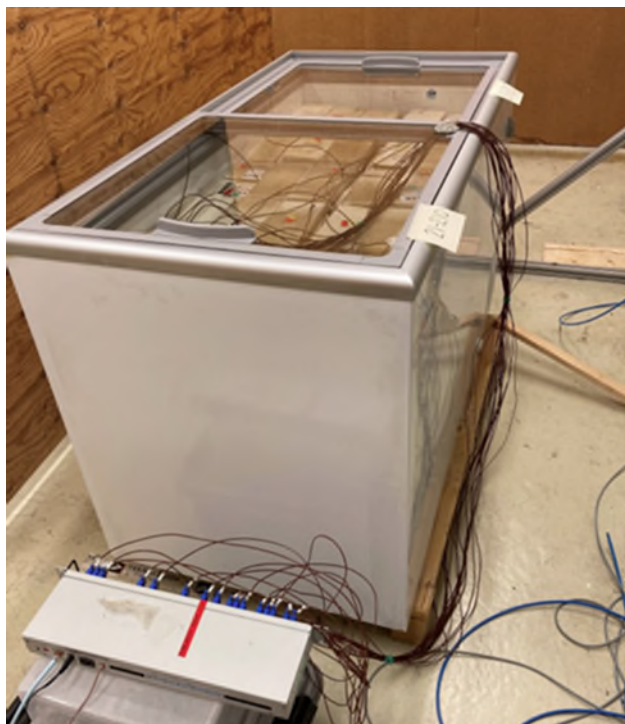
Figur: Prototype med de nye super-lavemmissionsglaslåger i klimakammer under test.
